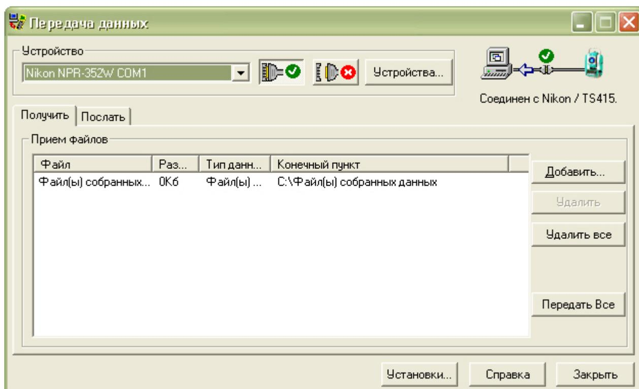
После этого в тахеометре из главного экрана измерений нажимаем Меню > Связь > Разгрузка
