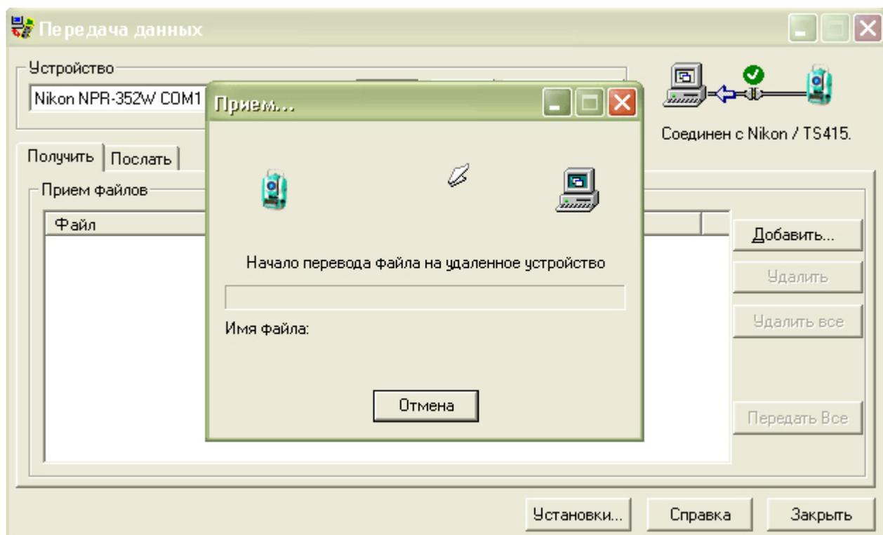
А в тахеометре нажимаем REC/ENT. Начнется передача данных. После передачи, тахеометр спросит об удалении переданного файла. Жмем «Отмена» для сохранения данных в приборе.
