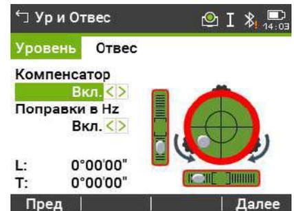
☞ Когда электронный уровень будет приведен в нульпункт, эти стрелки будут заменены галочками. Для цветного сенсорного дисплея: Если прибор не отгоризонтирован по одной оси, то контур круглого уровня и цилиндрических уровней выделяется красным, в противном случае контур черный.
