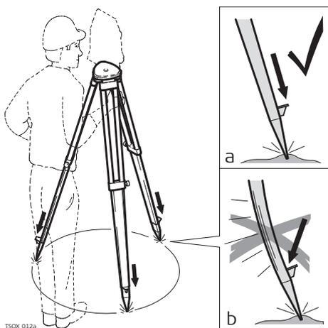
Слегка отпустите винты фиксации длины ножек штатива, и выдвиньте ножки на нужную длину и затяните винты.
