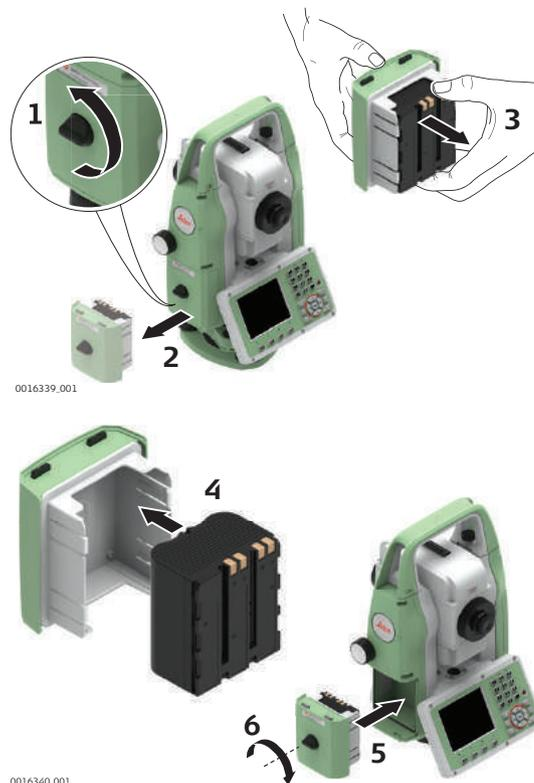
1. Поверните тахеометр так, чтобы винт вертикального круга был слева от вас. Батарейный отсек находится под винтом вертикального круга. Переведите фиксатор в вертикальное положение и откройте крышку батарейного отсека.
