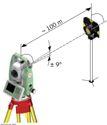
Наведите трубу на точку, находящуюся от инструмента на расстоянии примерно 100 метров и не более  $5^\circ$  от горизонтальной плоскости.
