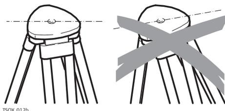
При установке инструмента старайтесь обеспечивать близкое к горизонтальному положение головки штатива. Небольшие коррекции при этом могут быть сделаны с помощью подъемных винтов подставки. Если наклон слишком велик, то изменяйте соответствующим образом выдвижение ножек штатива.
