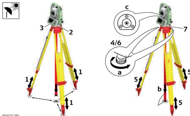
1. Выдвиньте ножки штатива для установки прибора в удобном рабочем положении. Установите штатив надо точкой и отцентрируйте его.
