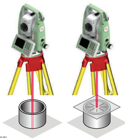
В некоторых случаях лазерное пятно отвеса не может быть видимым, например, при центрировании тахеометра над вертикальными трубами. В этой ситуации можно использовать прозрачную пластину для проектирования на нее луча лазерного отвеса и приведения его направления на геометрический центр трубы или колодца.
