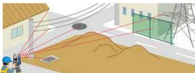
Ультразвуковой луч дальномера позволяет производить точное измерение стен, углов, люков на дорожной поверхности и даже сетчатых ограждений и ветвей деревьев.
